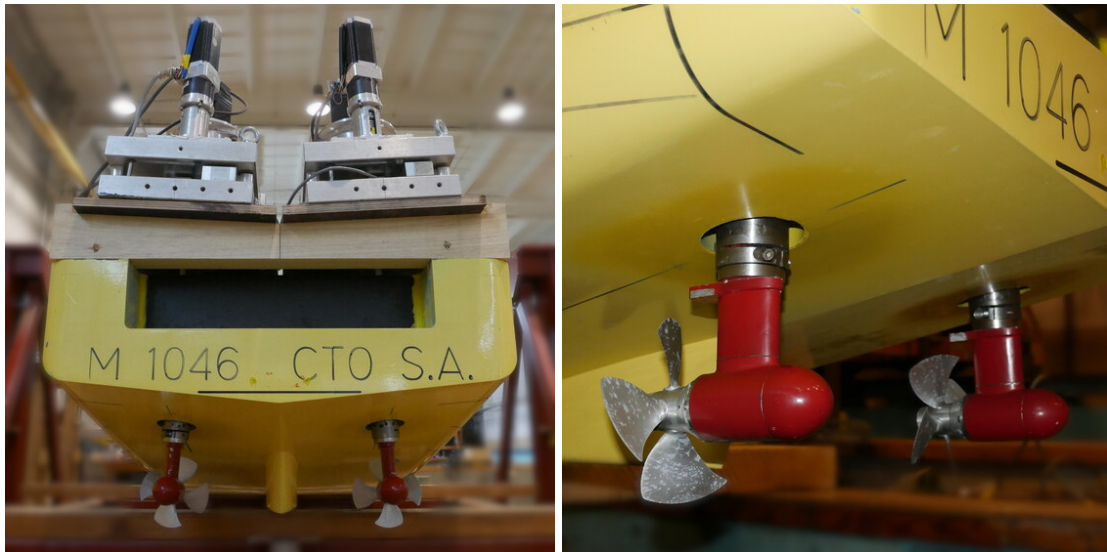
Rysunek 5.1: Rufowa część kadłuba modelu wraz z pędnikami azymutalnymi
